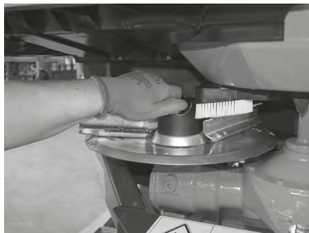
Obr. 40: Zaskrutkovanie uzavretej matice
