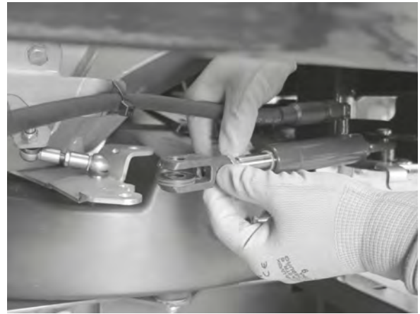
Şek. 73: Hidrolik silindirin çekip çıkarılması
