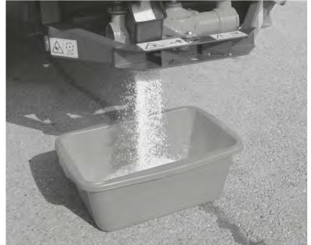
Şek. 39: Serpme testinin gerçekleştirilmesi
