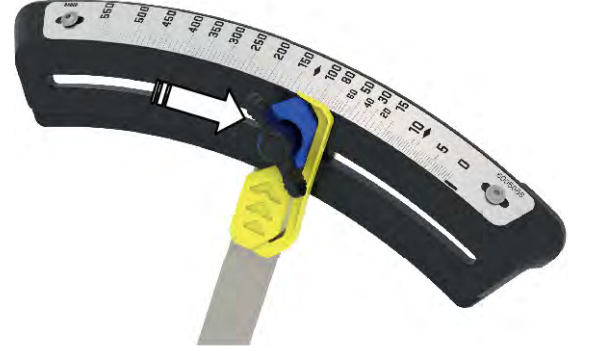
Şek. 75: Sınırlayıcının kaydırılması
