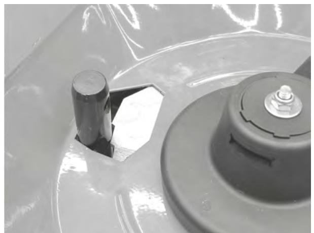
Σχ. 66: Μπουλόνι κάτω συνδέσμου μέσα στο δοσομετρικό άνοιγμα
