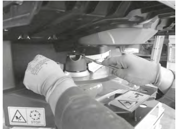
Σχ. 78: Χαλάρωση τυφλού παξιμαδιού
