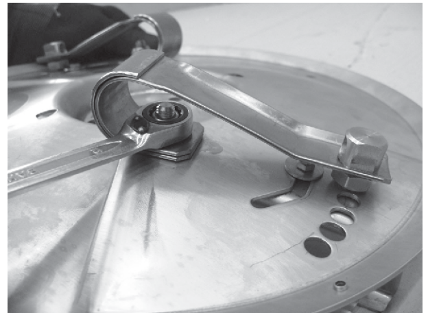
Σχ. 96: Στερέωση του επίπεδου ελατηρίου
