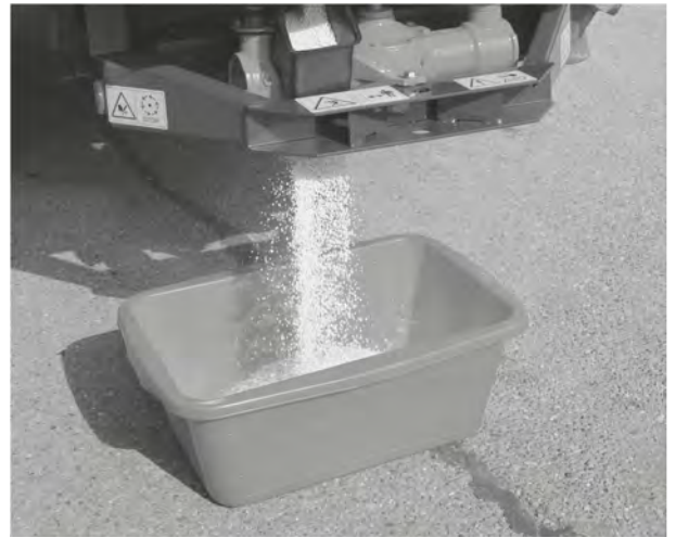
Σχ. 39: Εκτέλεση δοκιμής βαθμονόμησης
