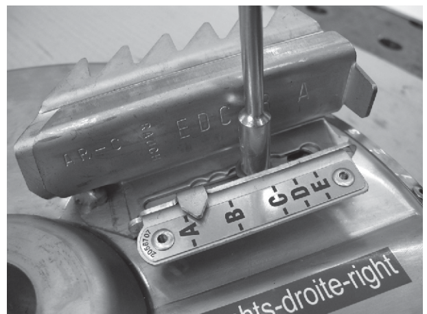
Σχ. 87: Σημεία στερέωσης των πτερυγίων ρίψης
