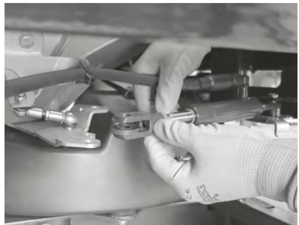
Ábr. 69: Hidraulikus henger kihúzása
