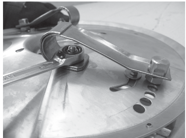
Ábr. 96: A laprugó rögzítése
