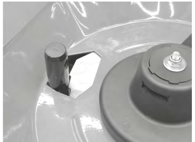
Ábr. 70: Alsó összekötőcsap az adagolónyílásban
