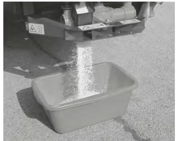
Ábr. 39: Leforgatási próba végrehajtása
