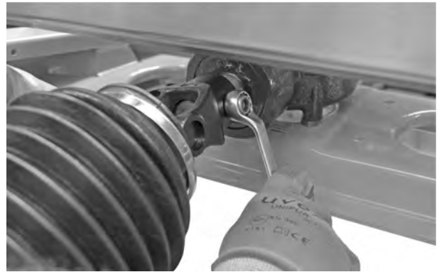
Ábr. 15: A kardántengely összekötése
