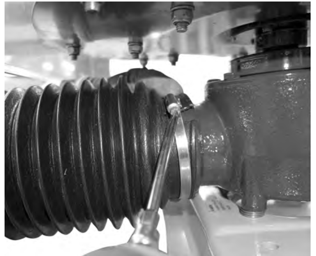
Ábr. 16: Kardántengely-védelem felhelyezése
