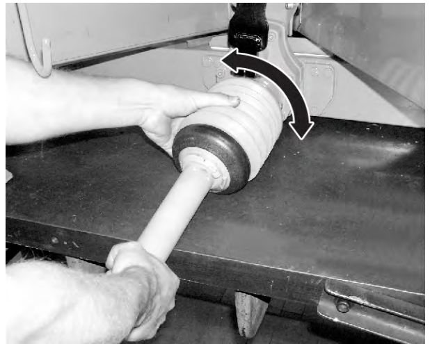
Ábr. 22: Kardántengely-védelem felhelyezése
