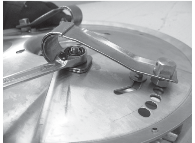
Ábr. 88: A csavarok kivétele
