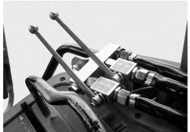
Ábr. 30: Kétutas szelep tolózárvezérlése
