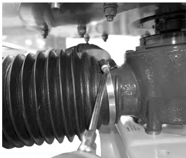
Fig. 16: Sett på kardangakselbeskyttelsen
