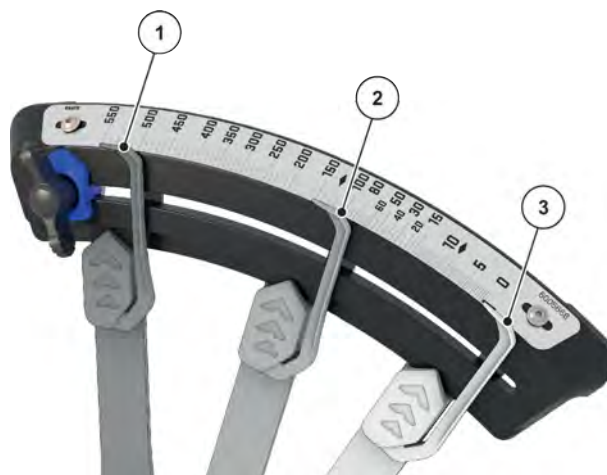
Fig. 31: Posisjon til doseringsskyveren
