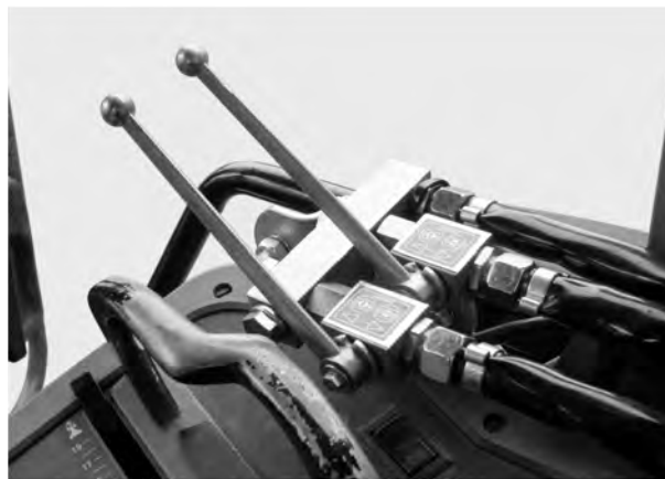
Fig. 30: Skyverbetjening av toveis-enheten
