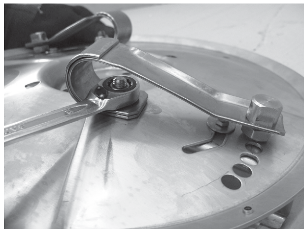
Sl. 96: Pritrjevanje ploščate vzmeti
