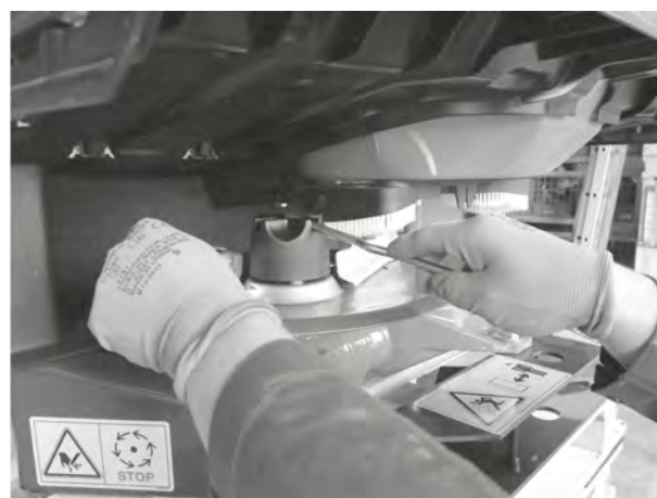
Sl. 37: Odvijanje klobučaste matice
