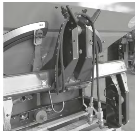
Ilust. 60: Apoio do eixo articulado, apoio dos cabos e mangueiras hidráulicas
