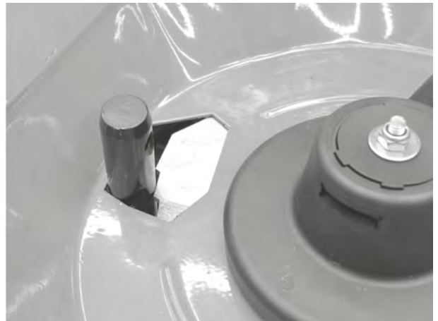
Ilust. 66: Pino do braço inferior na abertura de dosagem
