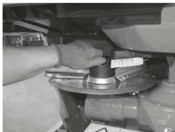
Ilust. 40: Aparafusar porca de capa
