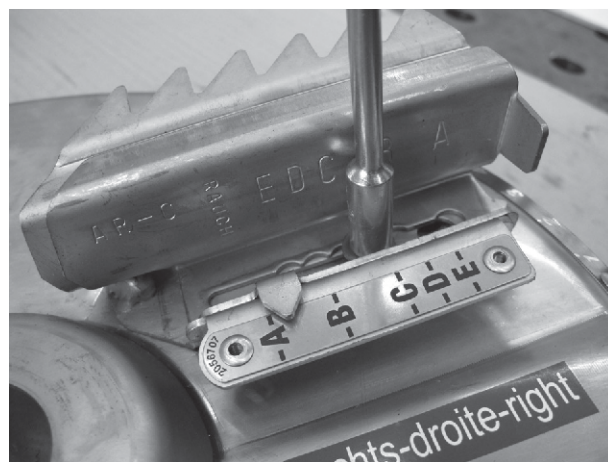
Rys. 89: Łopatki rozrzucające na tarczy rozrzucającej
