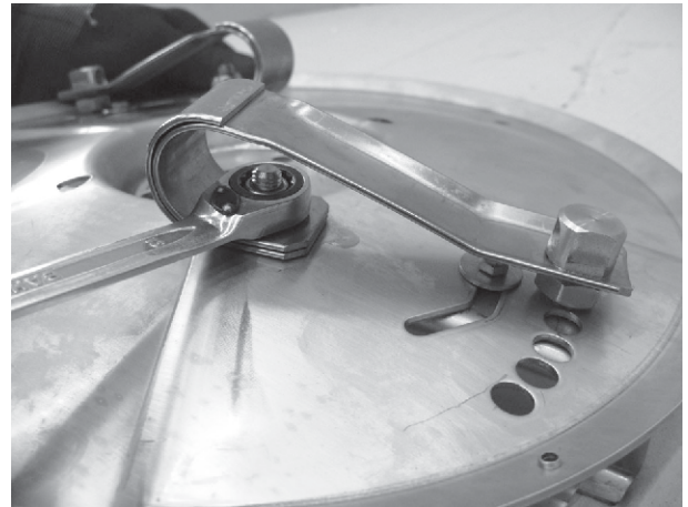
Rys. 92: Mocowanie sprężyn płaskich
