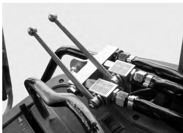
Rys. 30: Układ sterowania zasuwami jednostki dwudrogowej
