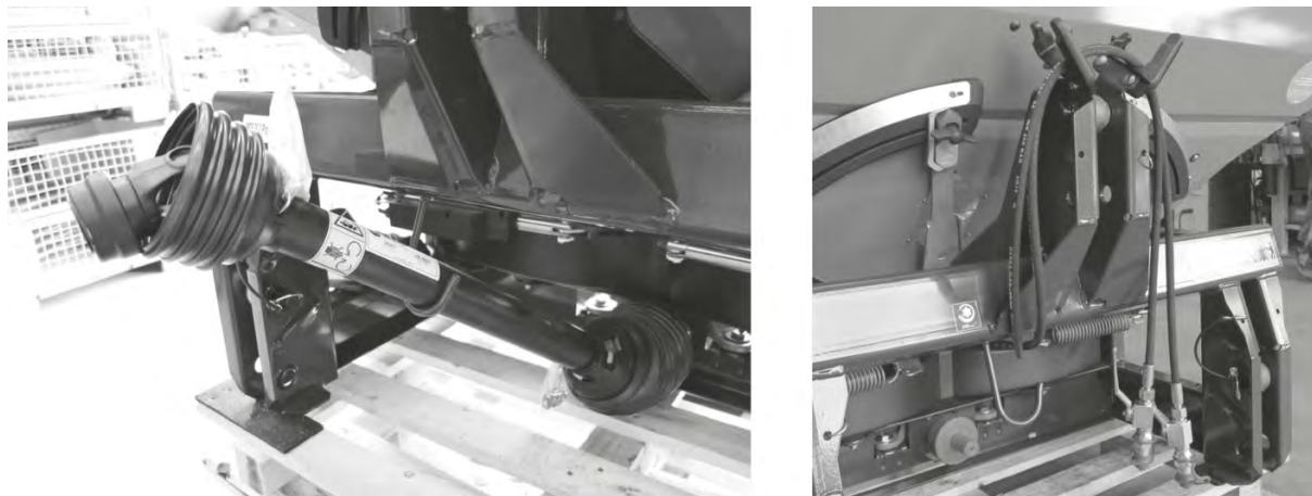
Rys. 64: Schowek na wał przegubowy, schowek na kable i giętkie przewody hydrauliczne
