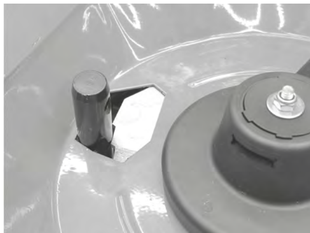
Rys. 70: Trzcina dolnego ramienia podnośnika w otworze dozującym
