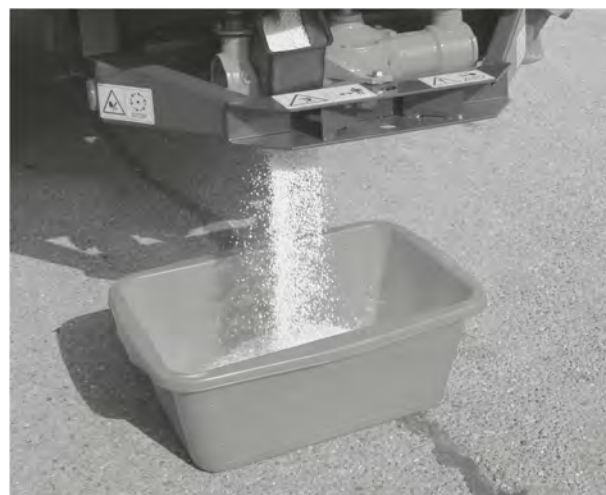
Rys. 39: Wykonanie próby rozsiewu
