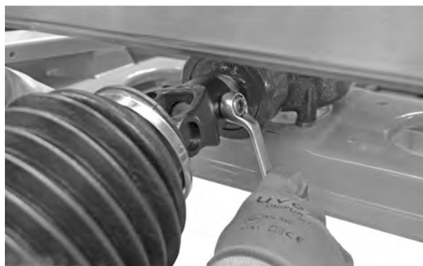
Rys. 15: Podłączanie wału przegubowego
