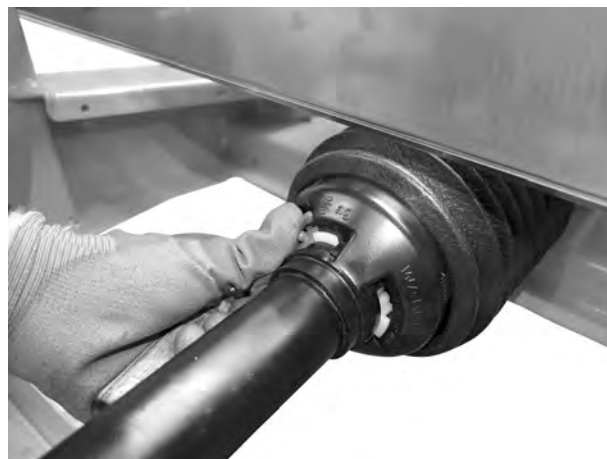
Rys. 17: Zabezpieczenie osłony wału przegubowego
