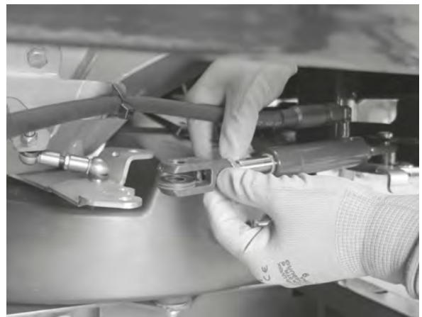
Rys. 73: Wysuwanie siłownika hydraulicznego
