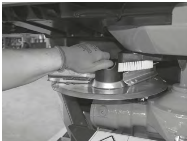
Rys. 40: Przykręcanie nakrętki kołpakowej
