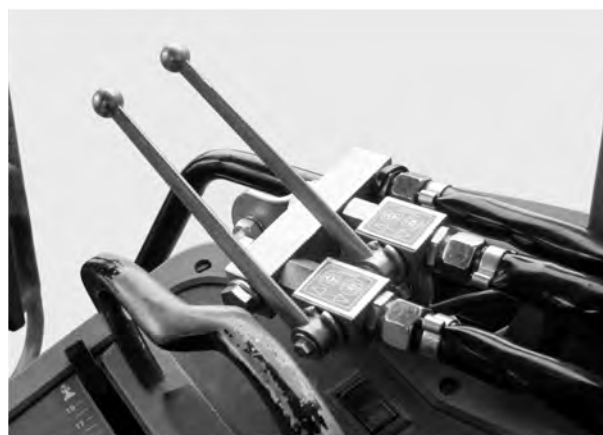
Rys. 30: Układ sterowania zasuwami jednostki dwudrożnej
