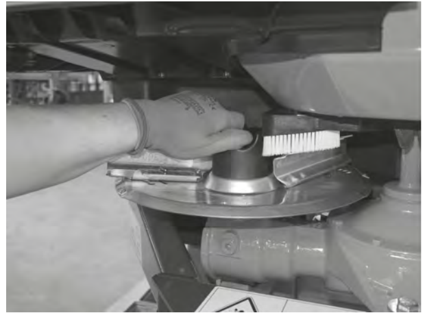
Att. 40: Kupoluzgriezņa pieskrūvēšana
