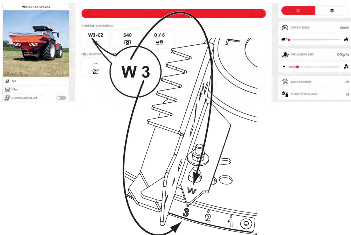
Jn. 44: Jaotustiiva seadistus jaotusketas M2, asend W3; W: fikseeritud pikkuse seadistus 1 kuni 6: Nurga seadistus
