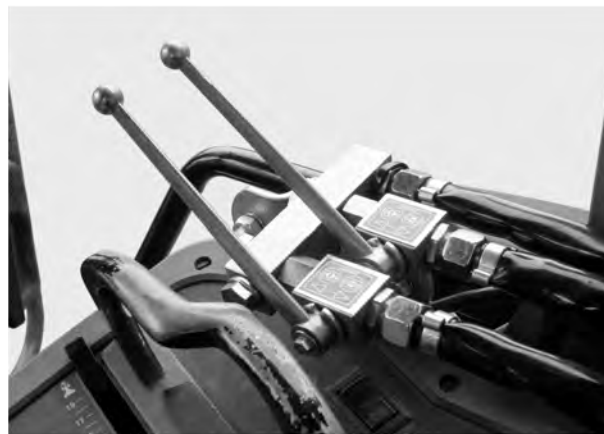
Jn. 30: Kahesuunalise üksuse klapimehhanism
