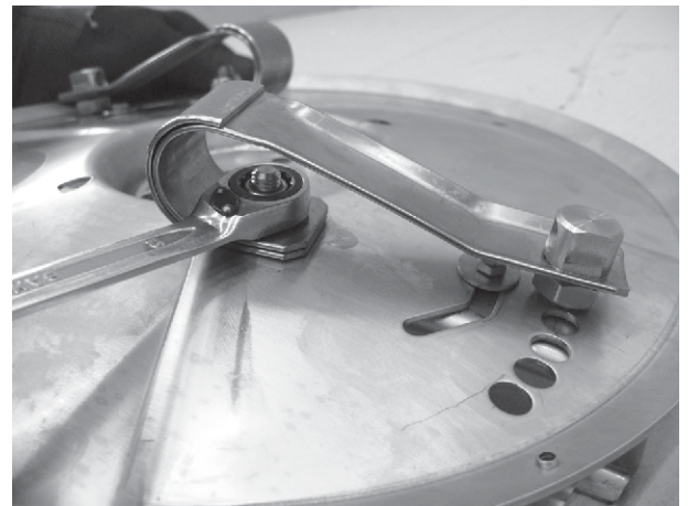
Pav. 96: Plokščiosios spyruoklės tvirtinimas
