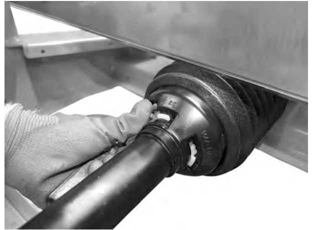
Pav. 17: Kardaninio veleno apsaugo užfiksavimas
