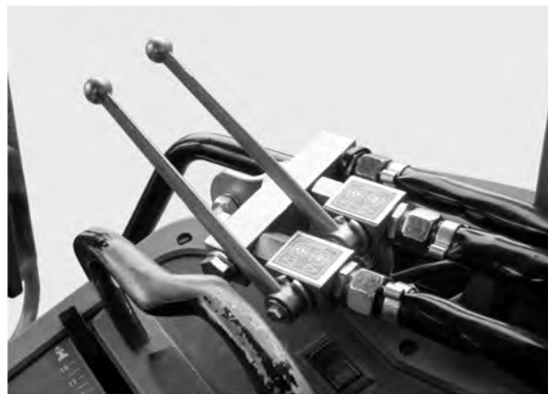
Pav. 30: Dviejų kanalų bloko sklendės valdymo įtaisai
