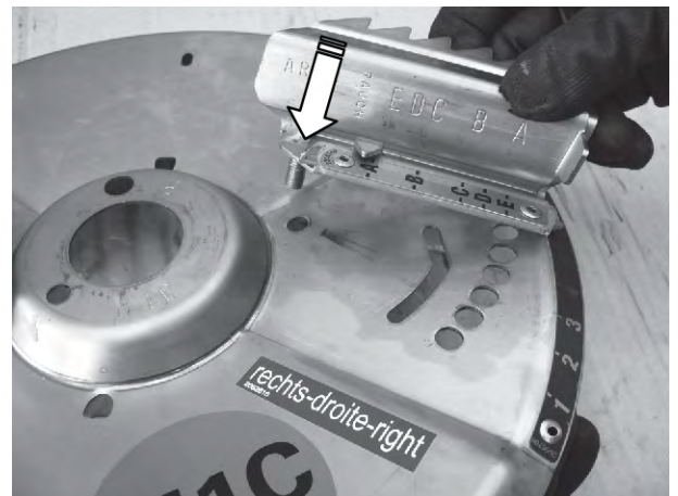
Pav. 92: Pagrindinės mentės montavimas
