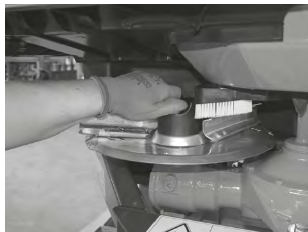
Фиг. 40: Завинтване на глухата гайка
