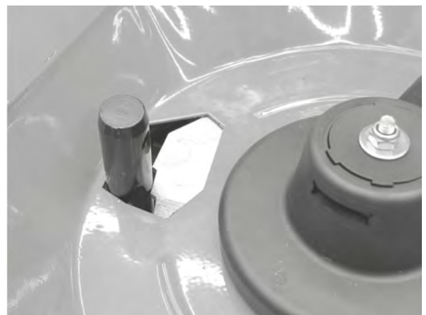
Фиг. 66: Болт на долния свързващ прът в дозиращия отвор
