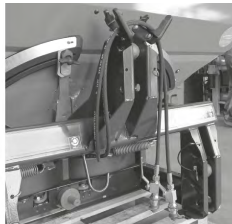
Фиг. 60: Място за съхранение на карданныя вал, на кабелите и на хидравличните маркучи
