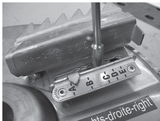
Фиг. 83: Точки на закрепване на разпръскващите лопатки
