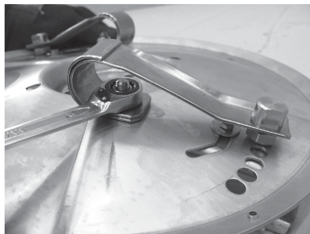
Фиг. 92: Закрепване на плоската пружина
