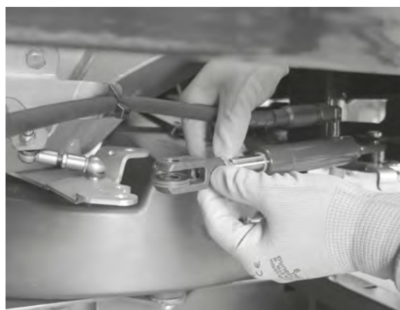
Фиг. 69: Изваждане на хидравличния цилиндър
