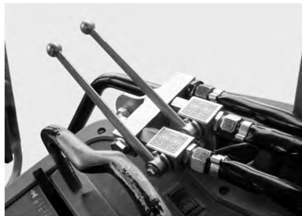
Фиг. 30: Задействане на шибъра на двустранното устройство
