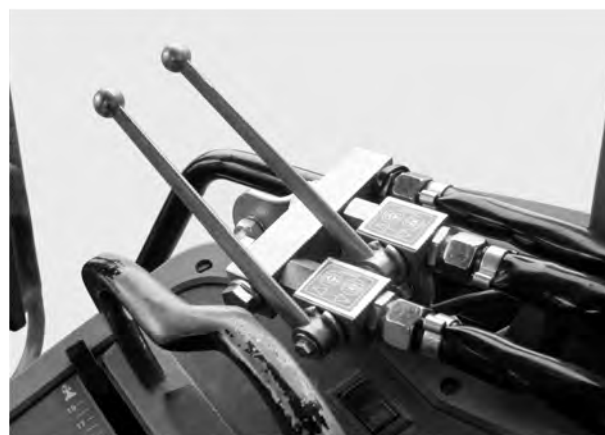
Рис. 30: Управление заслонками с помощью двухходового блока
