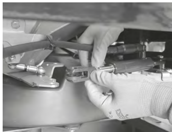
Рис. 73: Извлечение гидравлического цилиндра
