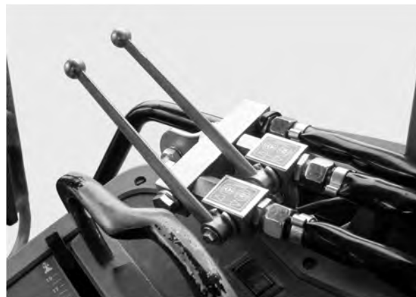
Рис. 30: Управление заслонками с помощью двухходового блока
