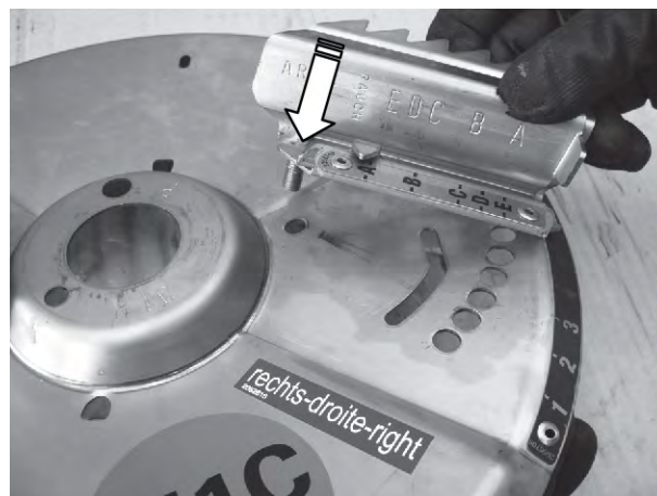
Рис. 92: Монтаж основной лопатки
