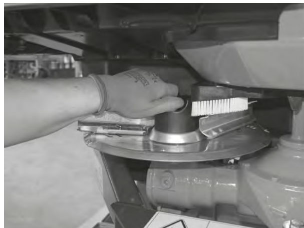
Рис. 40: Закручивание колпачковой гайки
