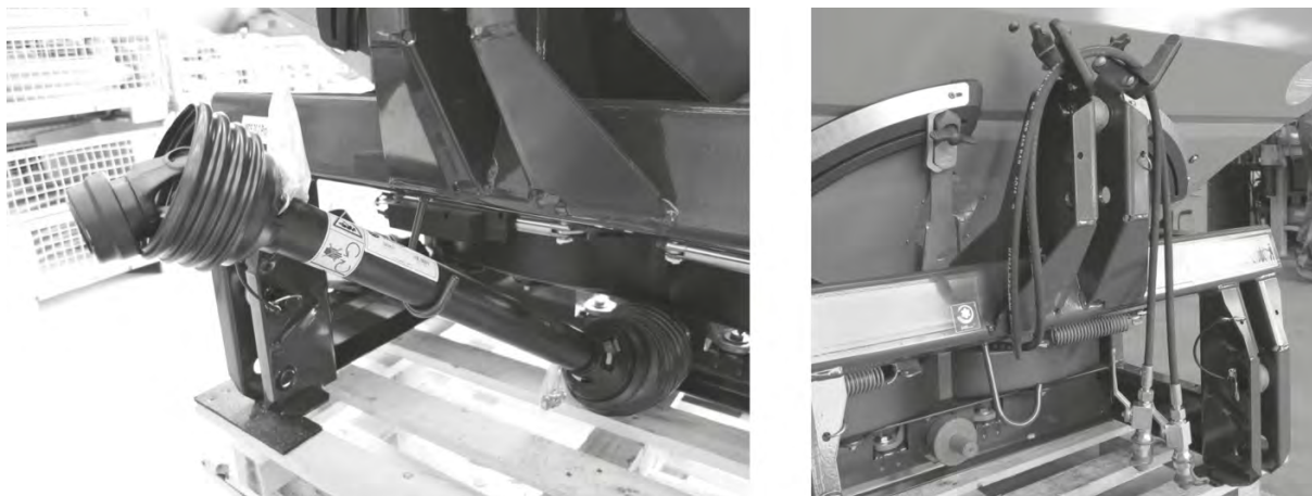
Рис. 64: Место размещения карданного вала, кабелей и гидравлических шлангов
