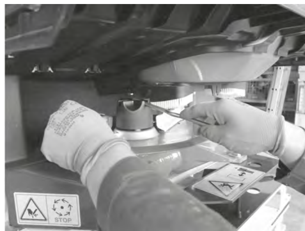
Рис. 37: Отвинчивание колпачковой гайки
