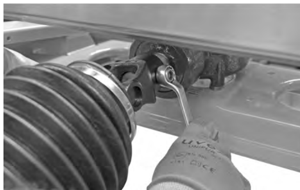
Рис. 15: Соединение карданного вала
