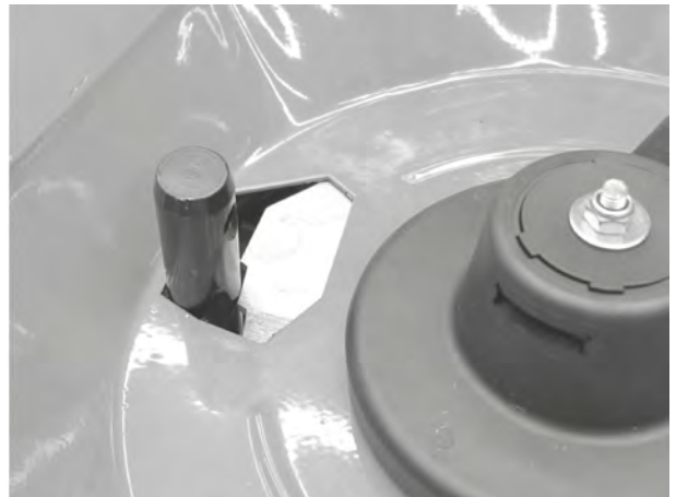
Рис. 70: Болт нижней тяги в дозирующем отверстии
