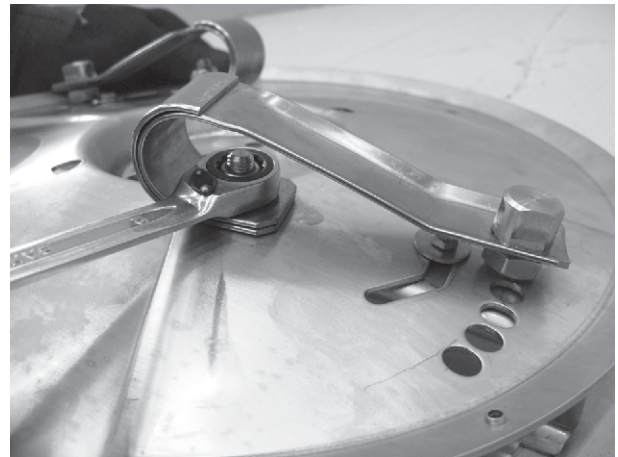
Рис. 96: Закрепление плоской пружины
