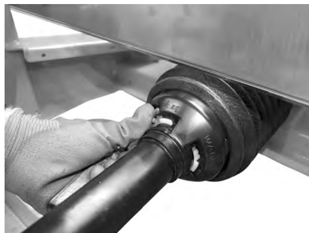
Рис. 17: Фиксация защитного кожуха карданного вала
