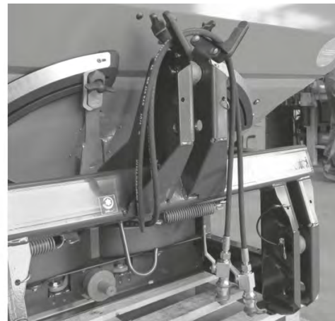
Obr. 60: Uložení kloubového hřídele, uložení kabelů a hydraulických hadic
