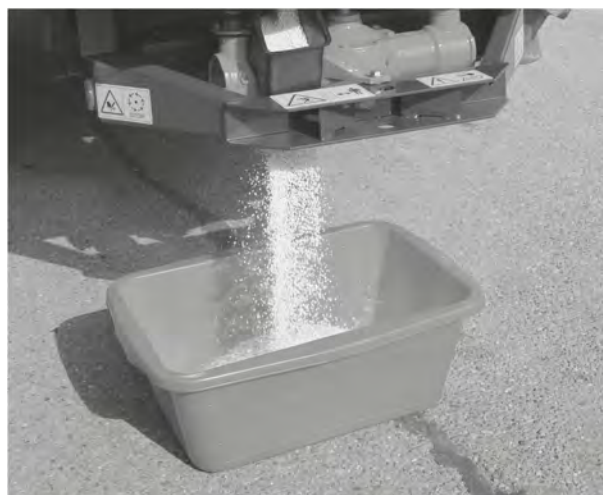
Obr. 39: Provedení zkoušky dávky
