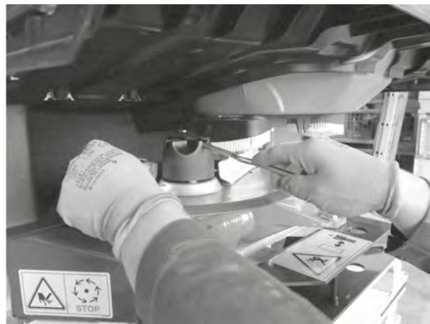
Obr. 78: Povolení uzavřené matice
