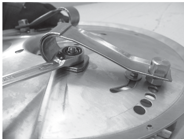
Obr. 96: Upevnění ploché pružiny
