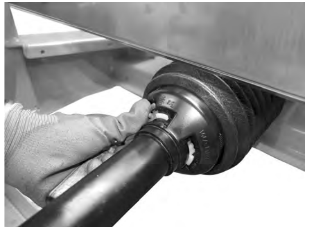
Obr. 17: Zajištění krytu kloubového hřídele
