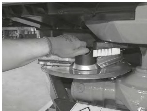
Obr. 40: Zašroubování uzavřené matice
