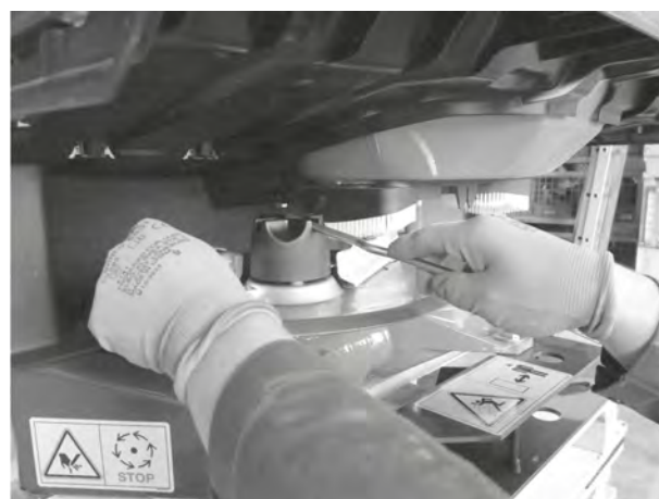
Obr. 37: Povolení uzavřené matice
