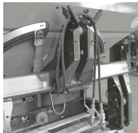
*Ilust. 60: Sujeción del eje articulado, de los cables y de las mangueras hidráulicas*
