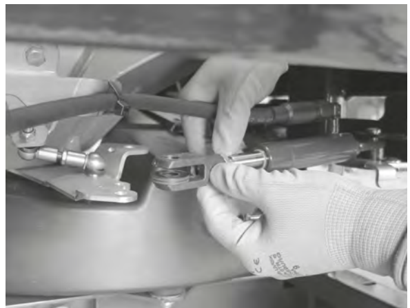
Afb. 69: Hydraulische cilinder naar buiten trekken
