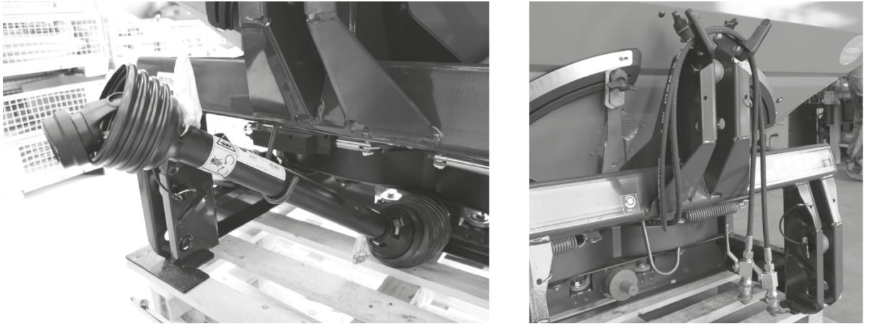
Afb. 62: Neerleggen van de aftakas, neerleggen van de kabels en hydraulische slangen
