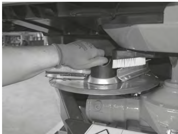
Fig. 40: Iskruning af kalotmøtrikken
