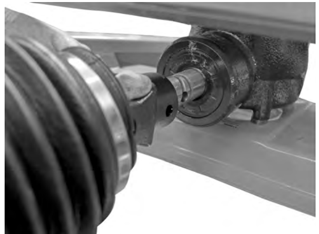
Fig. 14: Montering af kardanaxslen på akseltappen
