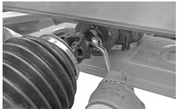
Fig. 15: Forbindelse med kardanaxslen
