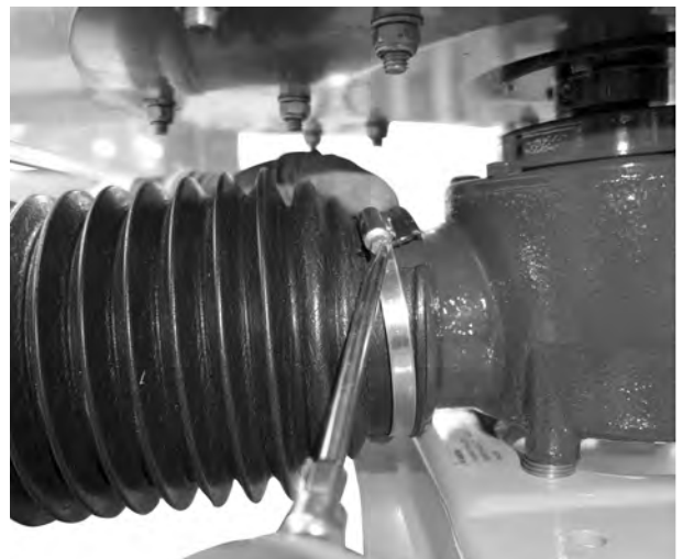
Fig. 16: Påsætning af kardanaxselbeskyttelsen
