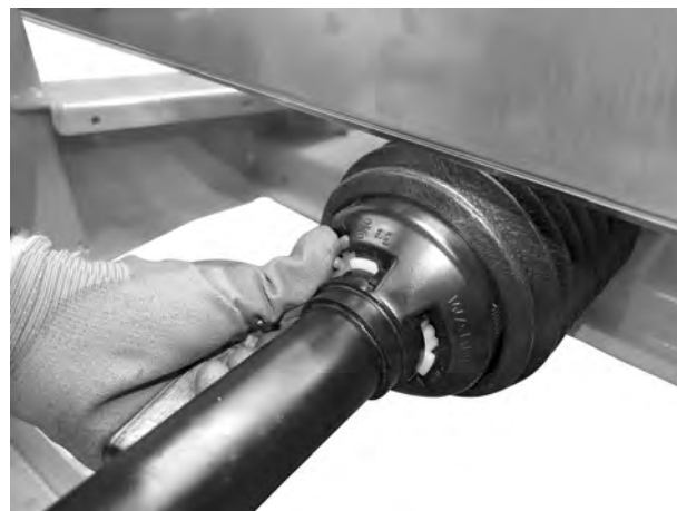
Fig. 17: Sikring af kardanakselbeskyttelsen
