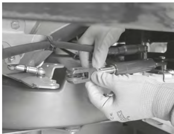
Fig. 73: Træk hydraulikcylinderen ud
