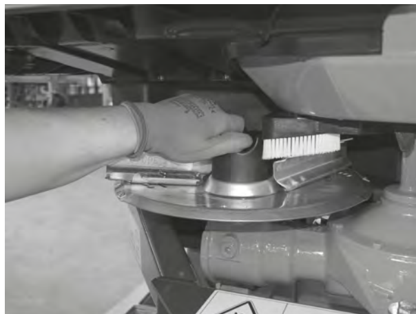
Fig. 40: Iskruning af kalotmøtrikken
