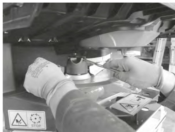
Fig. 37: Løsning af kalotmøtrikken
