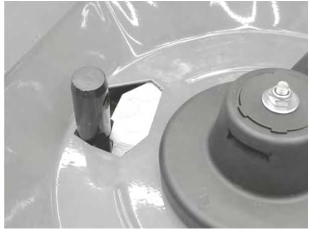
Fig. 70: Trækstangbolt i doseringsåbningen
