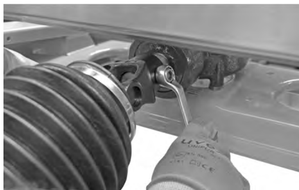
Fig. 15: Forbindelse med kardanaxslen
