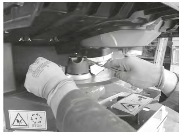
Fig. 37: Loosening the cap nut
