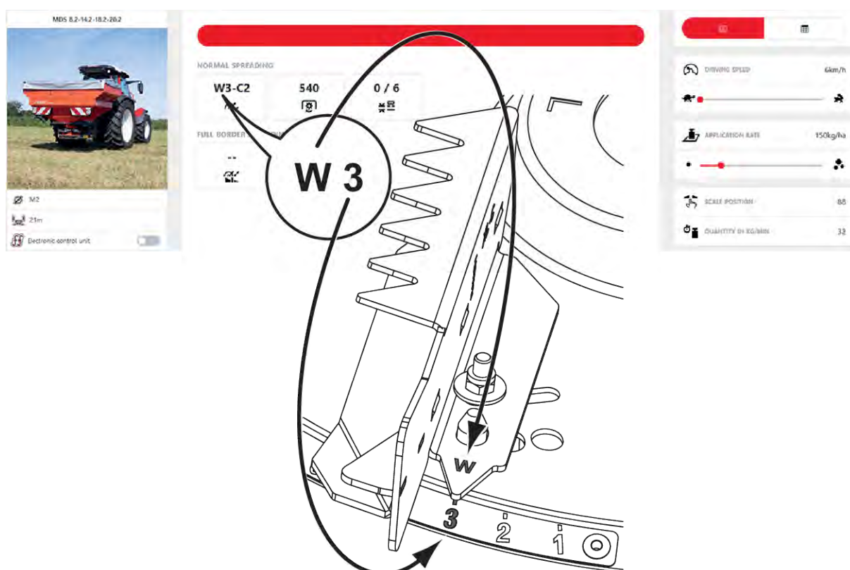
Fig. 44: Réglage des palettes, disque d'épandage M2, position W3 ; W : réglage de longueur fixe 1 à 6 : Réglage de l'angle
