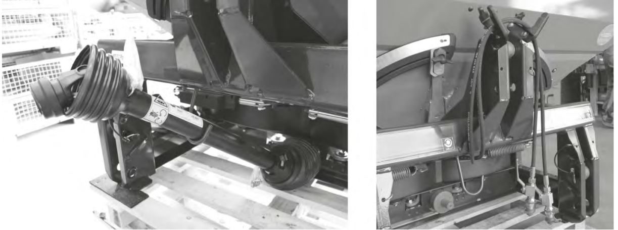
Abb. 64: Ablage der Gelenkwelle, Ablage der Kabel und Hydraulikschläuche
