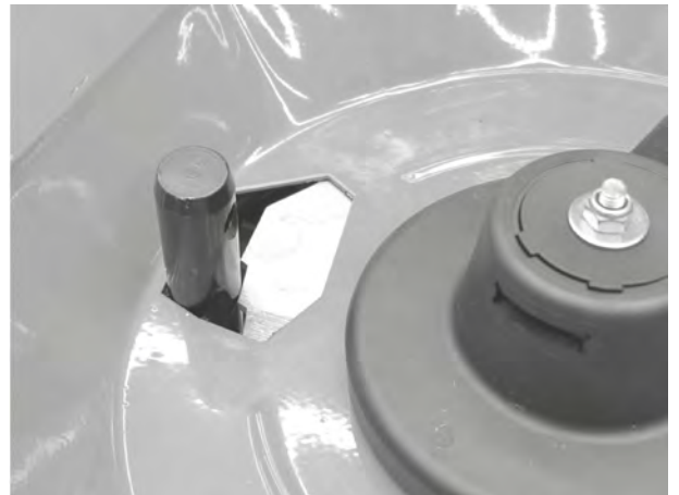
Abb. 70: Unterlenkerbolzen in Dosieröffnung
