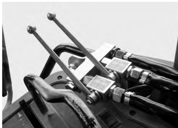
Abb. 30: Schieberbetätigung der Zwei-Wege-Einheit
