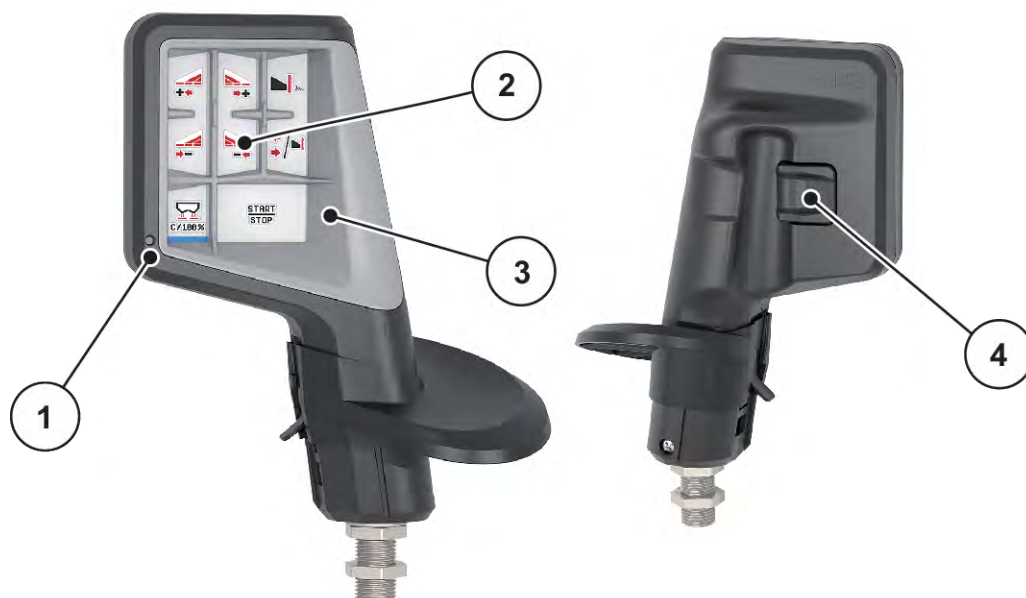
Рис. 26: CCI A3 Джойстик, передняя и задняя сторона
