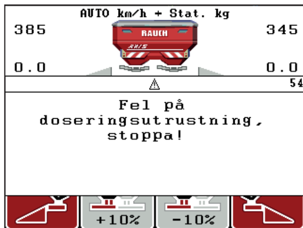
Bild 6.1: Larmmeddelande (exempel doseringsutrustning)
