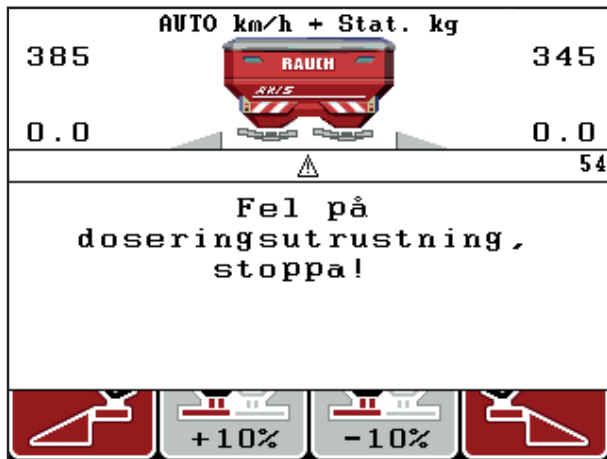
Bild 6.1: Larmmeddelande (exempel doseringsutrustning)
