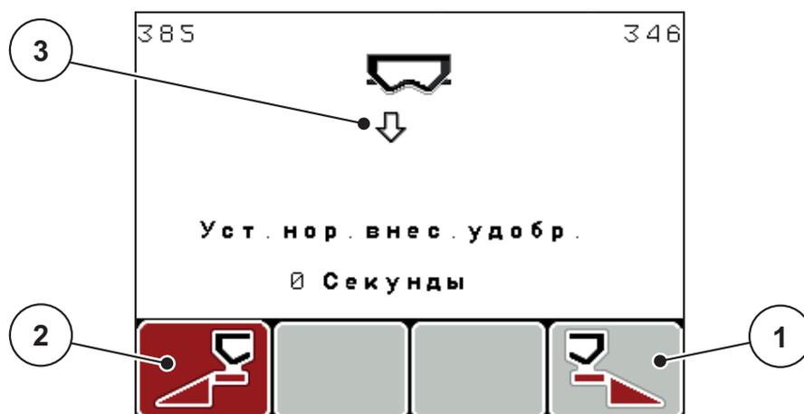
**Рисунок 4.11:** Рабочий экран «Подготовка установки нормы внесения удобрений»
