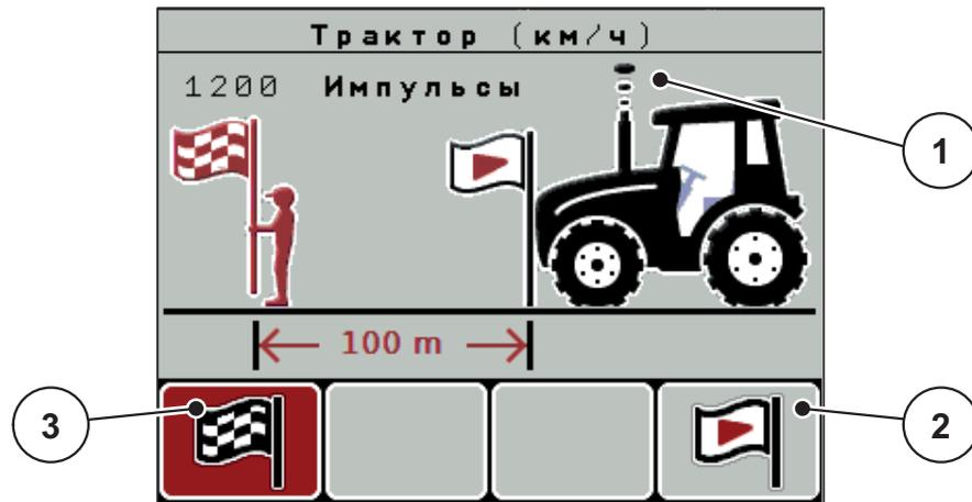
**Рисунок 4.20:** Рабочий экран «Калибровочная поездка для установки сигнала скорости»
