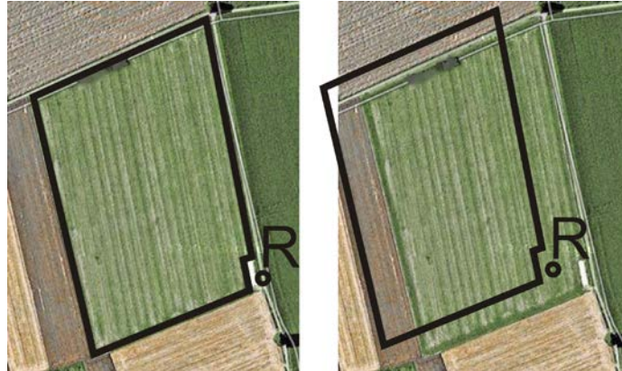
À gauche - champ avec signal GPS calibré; à droite - champ sans un signal GPS calibré
