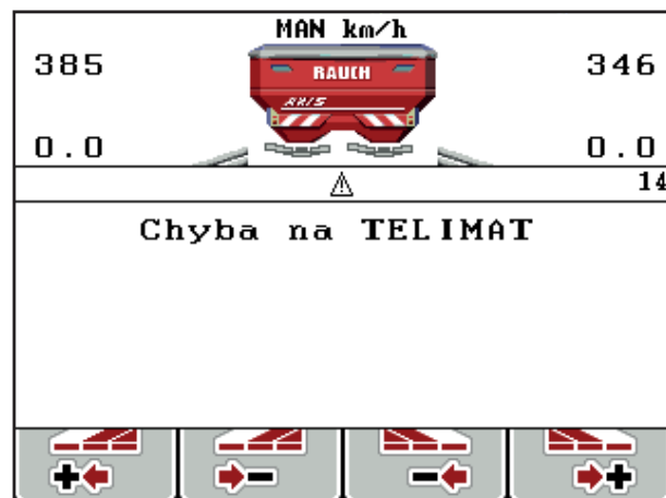
Obrázek 5.1: Zobrazení alarmového hlášení TELIMAT
