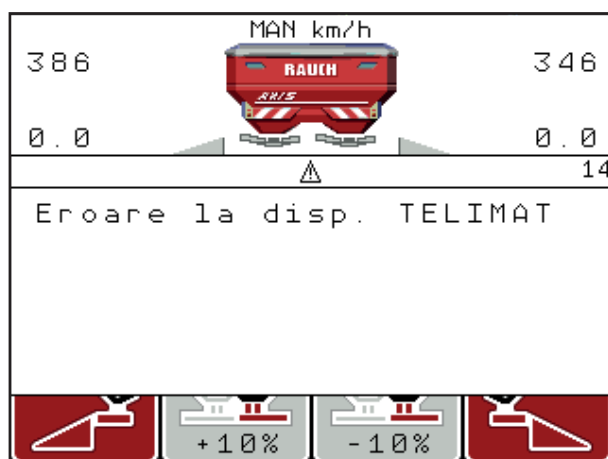
Imagine 5.1: Afișare mesaj de alarmă TELIMAT
