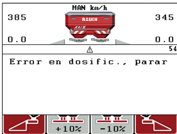
Imagen 6.1: Mensaje de alarma (ejemplo: equipo de dosificación)
