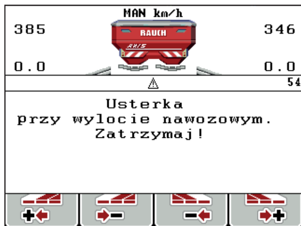
Rysunek 6.1: Komunikat alarmowy (na przykładzie urządzenia dozującego)
