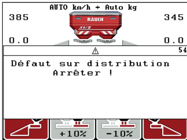
Figure 6.1 : Signal d'alarme (exemple distribution)
