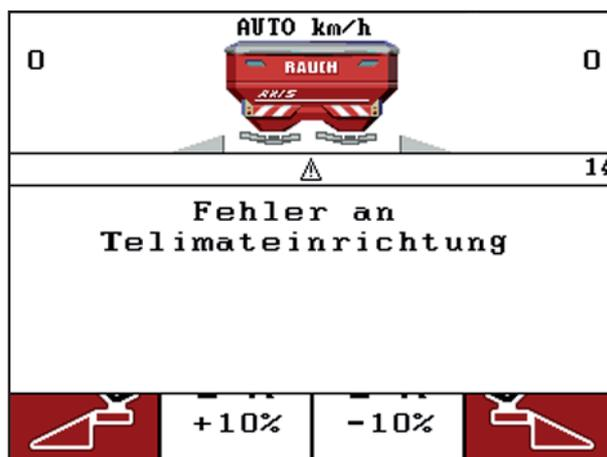
**Bild 5.1:** Anzeige Alarmmeldung TELIMAT
