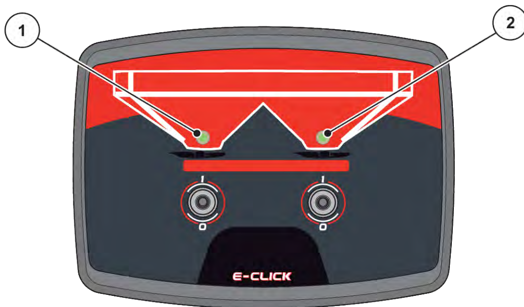
Obr. 3: Vícebarevné LED kontrolky
