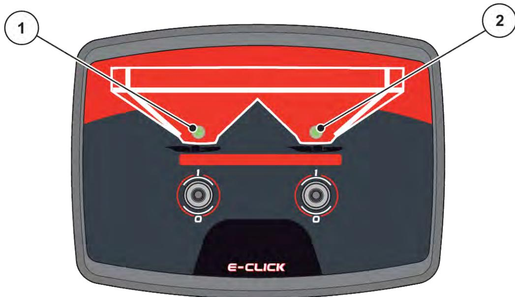
Abb. 3: Mehrfarbige LEDs
