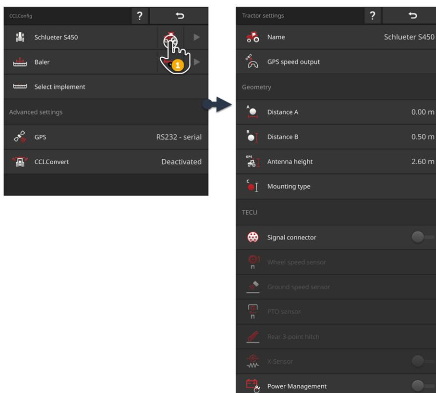
1. Dans le masque de commande « CCI.Config », appuyez sur le bouton « Réglages du tracteur ».
