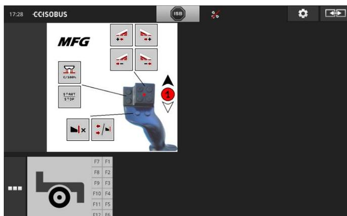
2. Sur l'unité de commande AUX, basculez dans tous les niveaux de commande et contrôlez l'affectation AUX sur le terminal.
