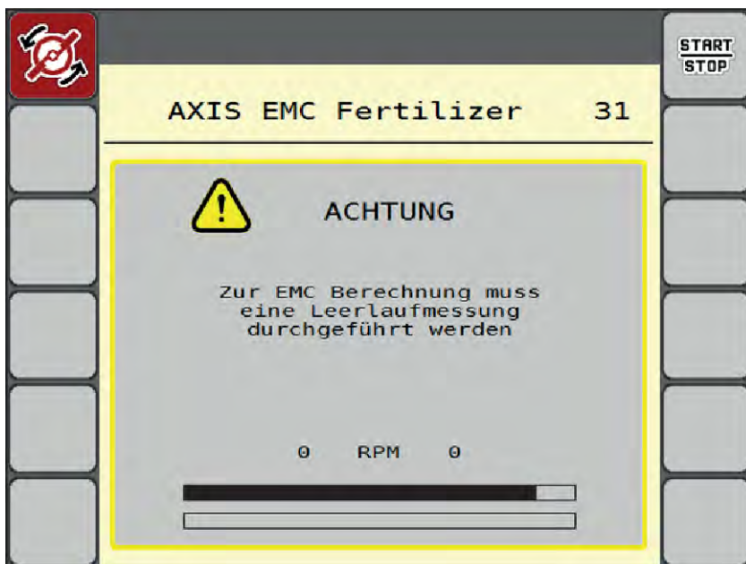
Рис. 43: Індикація попереджувального повідомлення вимірювання на холостому ході
