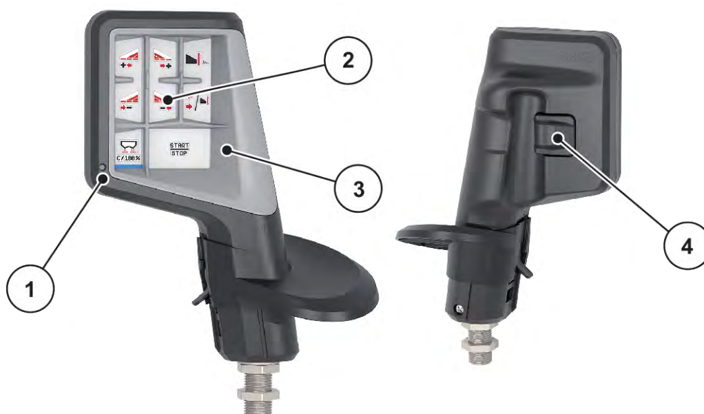
Σχ. 31: Joystick CCI A3, μπροστινή και πίσω πλευρά
