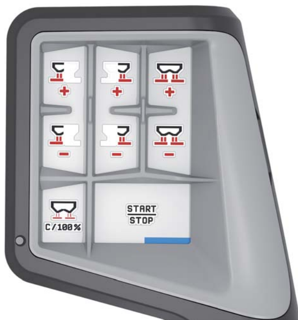
Slika 4.25: Raspored tastera, nivo 3
