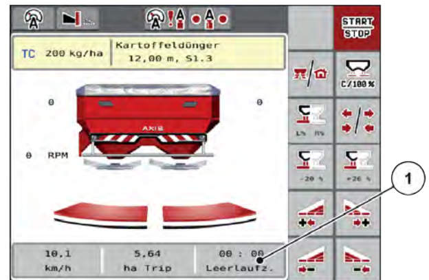
Kuva 49: Tyhjäkäyntimittauksen näyttö käyttökuvarissa
