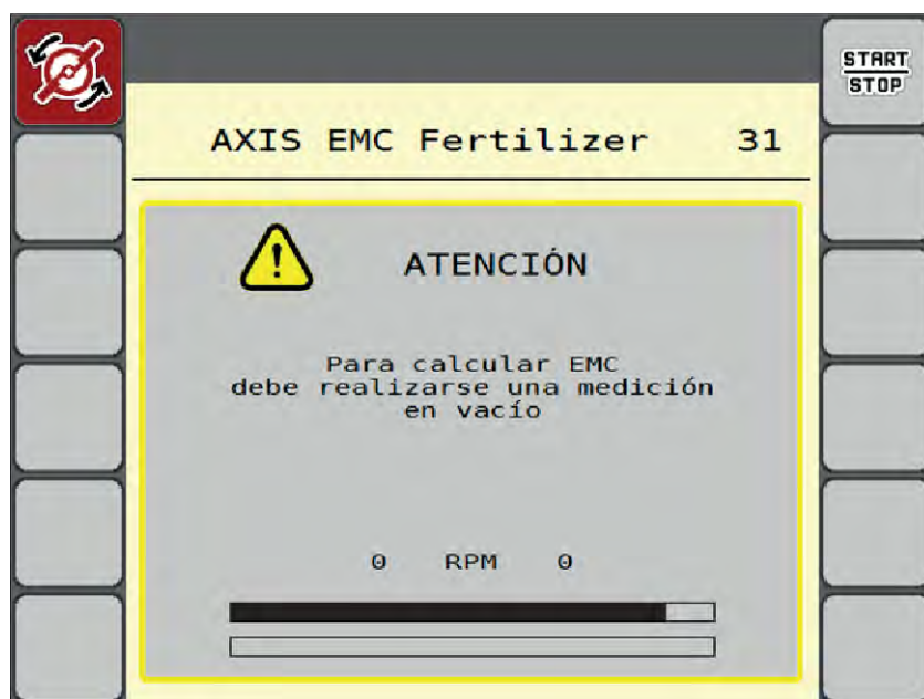
Ilust. 44: Indicador de alarma de medición de marcha en vacío
