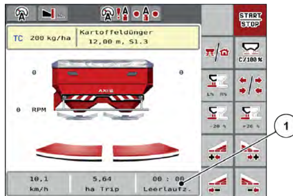
Fig. 49: Visning av tomgångsmätningen på driftskärmen.
