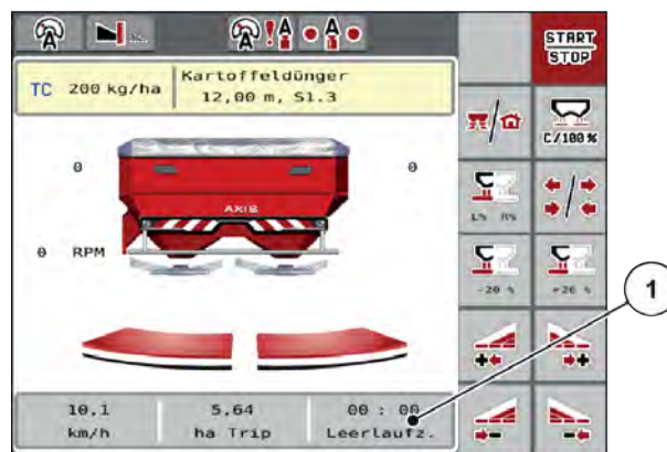
Jn. 49: Tühikäigumöötmise näit töökuval
