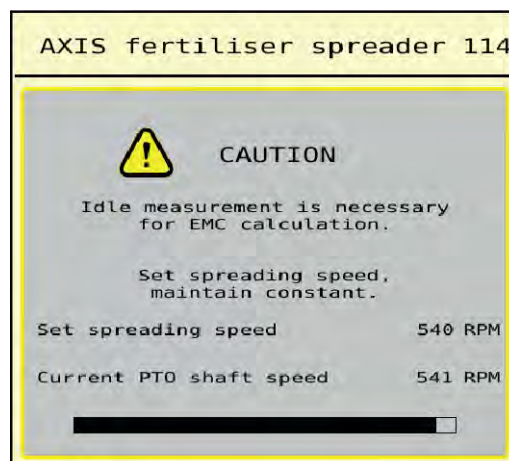
Obr. 48: Alarmová signalizace měření vyprázdnění
