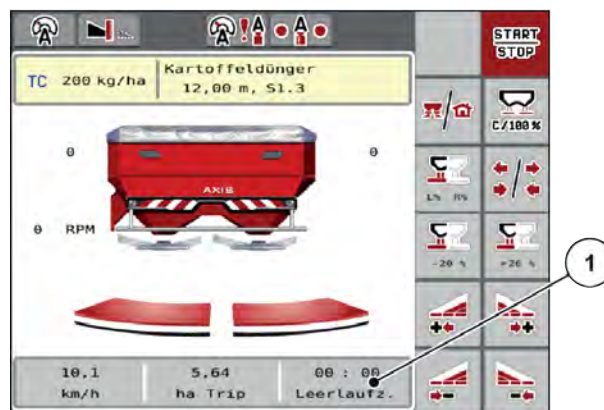
Rys. 49: Wskazanie pomiaru biegu jałowego na ekranie roboczym
